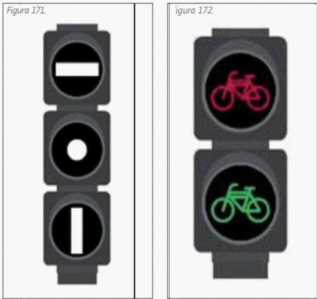
Figura 171. Semaforización dirigida a vehículos de transporte público
