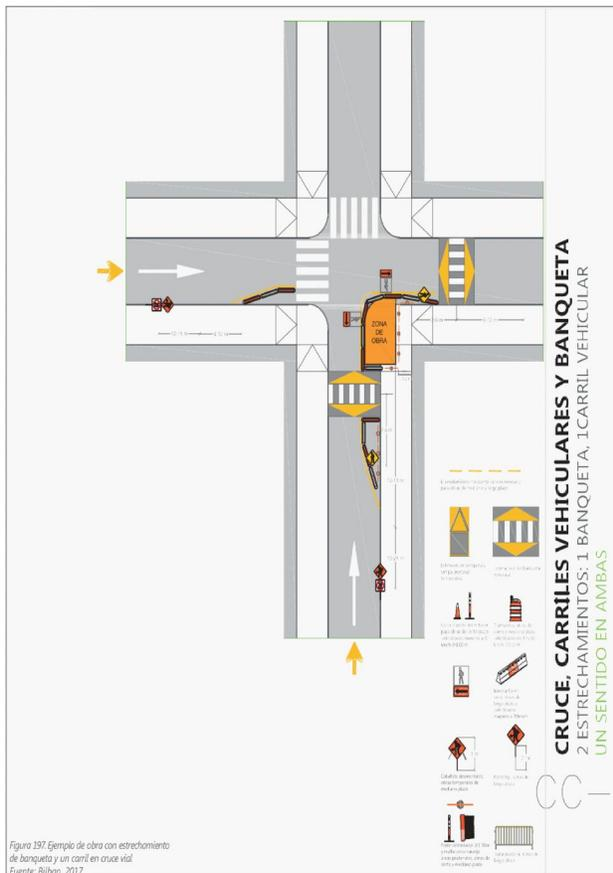
Figura 197. Ejemplo de obra con estrechamiento de banqueta y un carril en cruce vial
