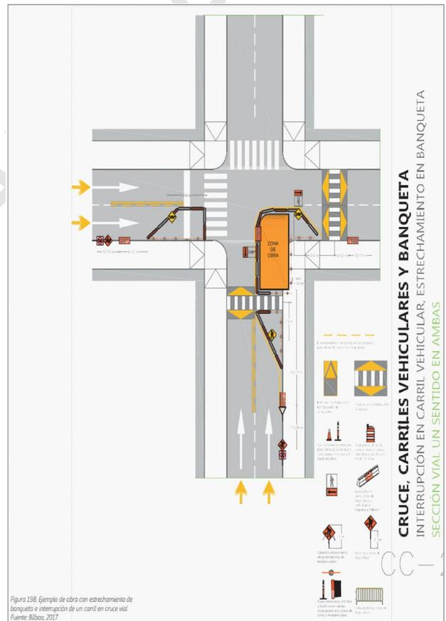
Figura 198. Ejemplo de obra con interrupción de banqueta y un carril en cruce vial
