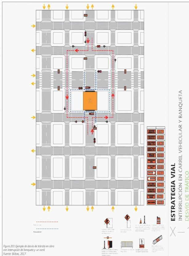
Figura 203. Ejemplo de desvío de tránsito en obra con interrupción de banqueta y un carril. Fuente: Bilbao, 2017.
