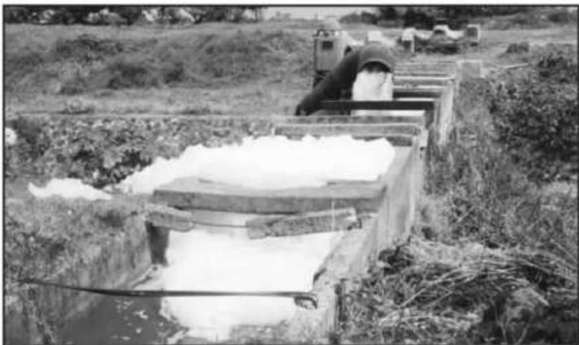
LA CARGA DE HUEVO, EN COMBINACIÓN CON LA CAL Y EL ÓXIDO DE MAGNESIO, ES CAPAZ DE ABSORBER METALES COMO MERCURIO, ZINC, CADMIO Y PLOMO
