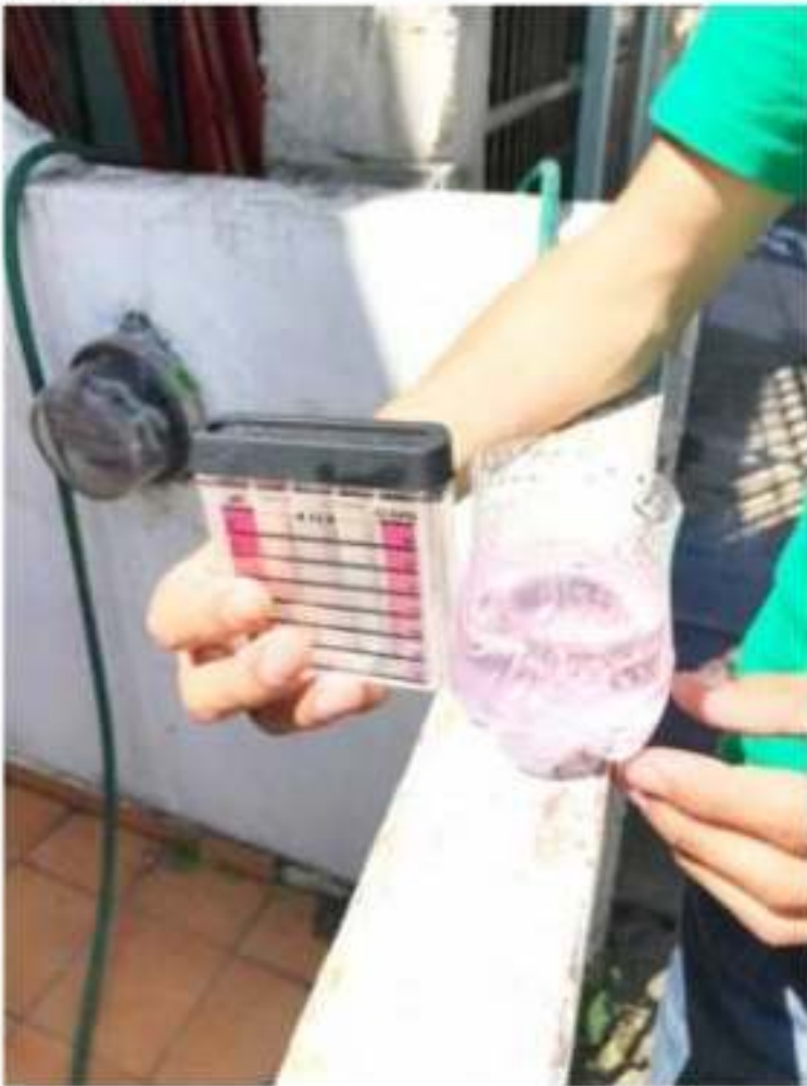
LOS REYES, MICH.- De manera periódica, el Sapad supervisa los niveles de cloración del agua potable.
